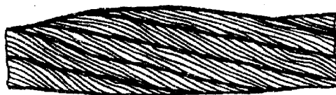
Рис. 13. Местное увеличение диаметра каната
