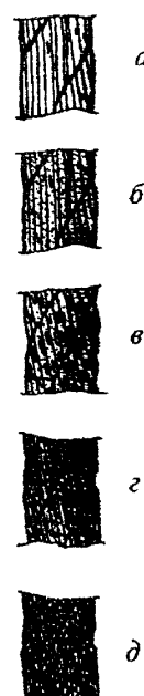
Рис. 6. Поверхностная коррозия проволок каната крестовой свивки: a — начальное окисление поверхности; б — общее окисление поверхности; в — заметное окисление; г — сильное окисление; д — интенсивная коррозия
